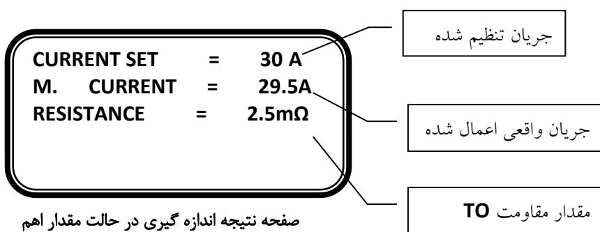
♣ برای بیرون آمدن از صفحه اندازه گیری و شروع اندازه گیری جدید باید کلید ESC زده شود.
