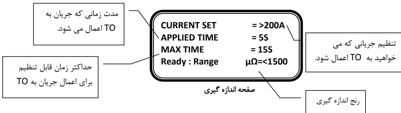
۳. در صفحه منحنی اهم با انتخاب گزینه 2>  $\mu\Omega > 1500$  (با زدن کلید 2) صفحه اندازه گیری در رنج  $\mu\Omega$  برای اندازه گیری مقاومت های بزرگتر از  $1500 \mu\Omega$  به صورت زیر مشاهده خواهد شد:
