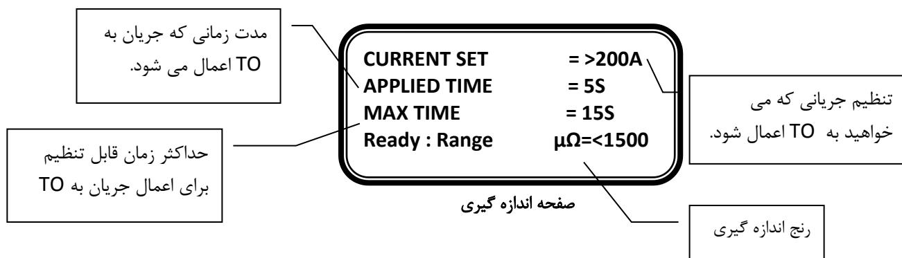
۳. در صفحه مقدار اهم با انتخاب گزینه  $\mu\Omega > 1500$  (با زدن کلید 2) صفحه اندازه گیری در رنج  $\mu\Omega$  برای اندازه گیری مقاومت های  $\mu\Omega > 1500$  به صورت زیر مشاهده خواهد شد:
