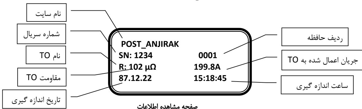
با زدن کلید می توانید مدت زمان اندازه گیری و ولتاژ اعمال شده را مشاهده نمایید.
